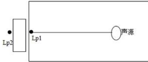
图 4-1 室内声源等效为室外声源图例
