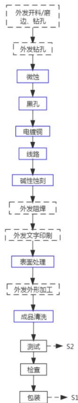
图2-4 多面板工艺流程图
