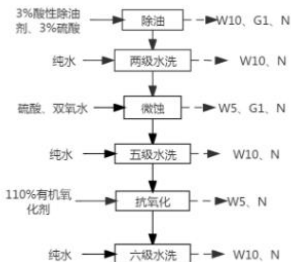
图2-9OSP抗氧化工艺流程图
