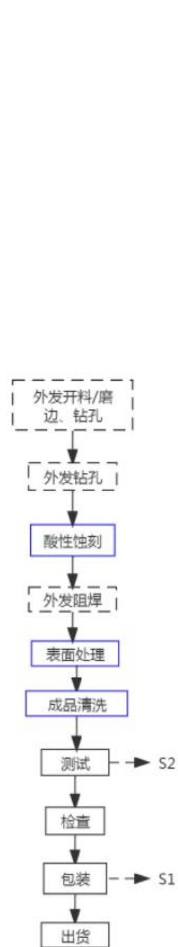
图2-2 单面板工艺流程图
