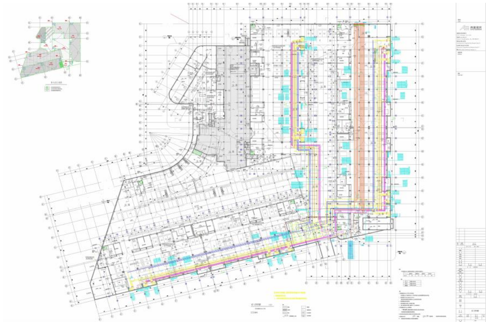
附图 18 碧环保科技创新产业园生产废水、事故废水、消防废水收集管线图
